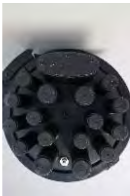
Entrées de câble
