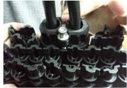
Entrées de câbles de raccordement.
